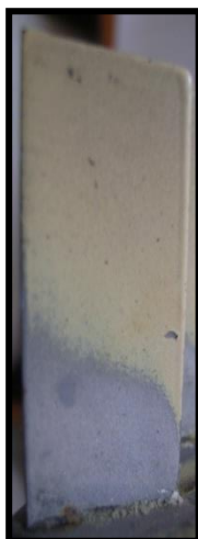
Рисунок 2. ПКГ износа покрытия лопатки НА статора компрессора
